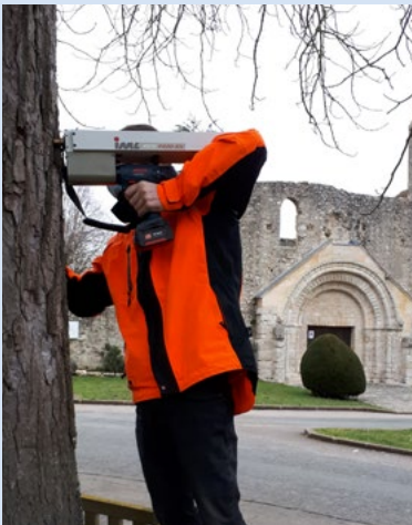
Test au résistographe réalisé par le technicien.
